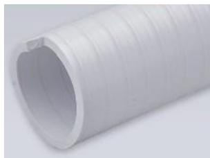
**HYDRO PVC** –напорно-всасывающий рукав, шланг белого цвета с ударопрочной спиралью из ПВХ. Доступные диаметры 16 мм – 102 мм. Внутри поверхность гладкая, снаружи гладкая. Очень гибкий даже при низких температурах. Прочный, устойчивый к атмосферным воздействиям и большинству химических веществ.
