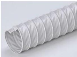
**НОТАIR PVC 100°C** - Гибкий воздуховод, изготовленный из огнестойкой полиэфирной ткани с покрытием из ПВХ и усиленный стальной спиралью, между двумя слоями вмонтирована стальная армирующая спираль. Материал является самозатухающим.
