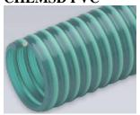
**CHEMSD PVC** — эластичный напорно-всасывающий рукав, шланг зеленого цвета с ударопрочной спиралью из ПВХ. Доступные диаметры 16 мм — 102 мм. Внутри поверхность гладкая, снаружи легкое гофрирование. Очень гибкий даже при низких температурах. Прочный, устойчивый к атмосферным воздействиям и большинству химических веществ.
