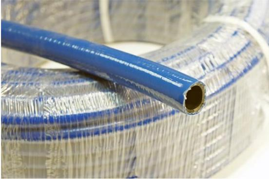
**СHEMD PVCР** – универсальный эластичный напорный рукав, шланг из смеси ПВХ и резины с текстильным кордом из полиэфирной нити. Доступные диаметры 6 мм – 25 мм. Внутри поверхность гладкая, снаружи гладкая синего цвета. Улучшенные механические свойства: очень гибкий, прочный, устойчивый к атмосферным воздействиям, старению и большинству химических веществ, длительный срок службы.
