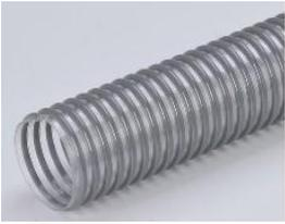
**AIRSD PVC** Рукав напорно-всасывающий прозрачный с армированием ПВХ спиралью серого или белого цвета, диапазон диаметров: 20 мм -160 мм. Гладкая внутренняя поверхность для улучшения свойств потока и легкой очистки после использования. Наружная поверхность гофрированная. Очень легкий и гибкий шланг, устойчив к воздействию ряда химических веществ и погодных условий. По запросу может быть изготовлена версия с медной стренгой.
